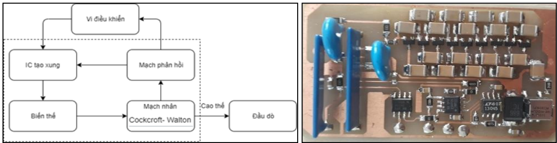
Hình 3. Sơ đồ hoạt động của khối cao thế và khối cao thế được chế tạo hoàn chỉnh.
