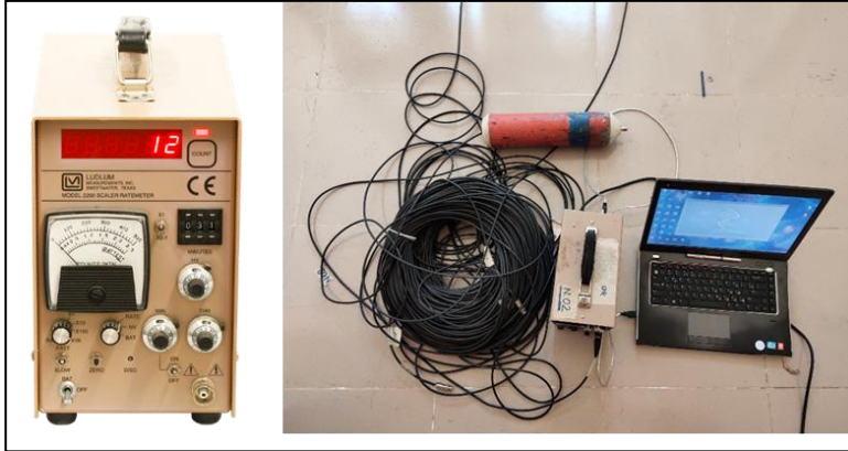
Hình 11. Hệ đo M2200 của hãng Ludlum dùng trong soi tháp tại CANTI.
